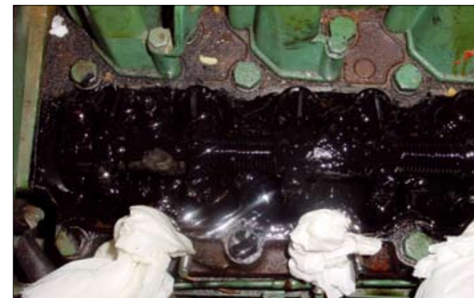
Volvo Penta Dieselmotor før innvendig motorvask
